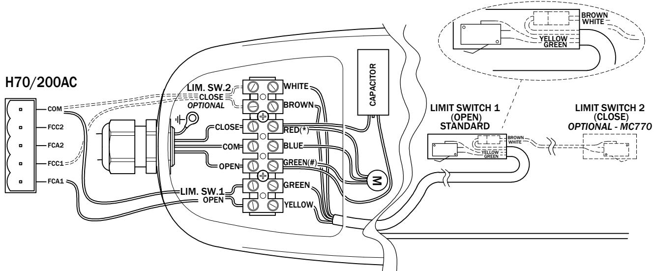
**2** Finecorsa di APERTURA collegato in serie alle fasi motore • OPENING limit switch connected in series to the motor phases • ÖFFNUNGS-Endschalter seriennäig an die Motorphasen angeschlossen • Fin de course d'OUVERTURE branché en série aux phases moteur • Final de carrera de APERTURA conectado en serie a las fases del motor • Fim de curso de ABERTURA ligado em série às fases do motor.
