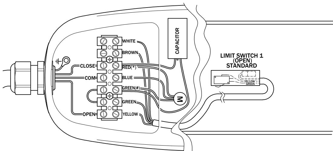
**3** Finecorsa di APERTURA e CHIUSURA collegati in serie alle fasi motore • OPENING and CLOSING limit switches connected in series to the motor phases • ÖFFNUNGS- und SCHLIESSENDSCHALTER seriennäig an die Motorphasen angeschlossen • Fins de course d'OUVERTURE et FERMETURE branchés en série aux phases moteur • Final de carrera de APERTURA y CIERRE conectados en serie a las fases del motor • Fim de curso de ABERTURA e FECHO ligados em série às fases do motor.
