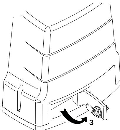
**ES** **¡ATENCIÓN!**: efectúe las operaciones de desbloqueo y bloqueo de las hojas después de quitar la corriente y con el motor parado.
